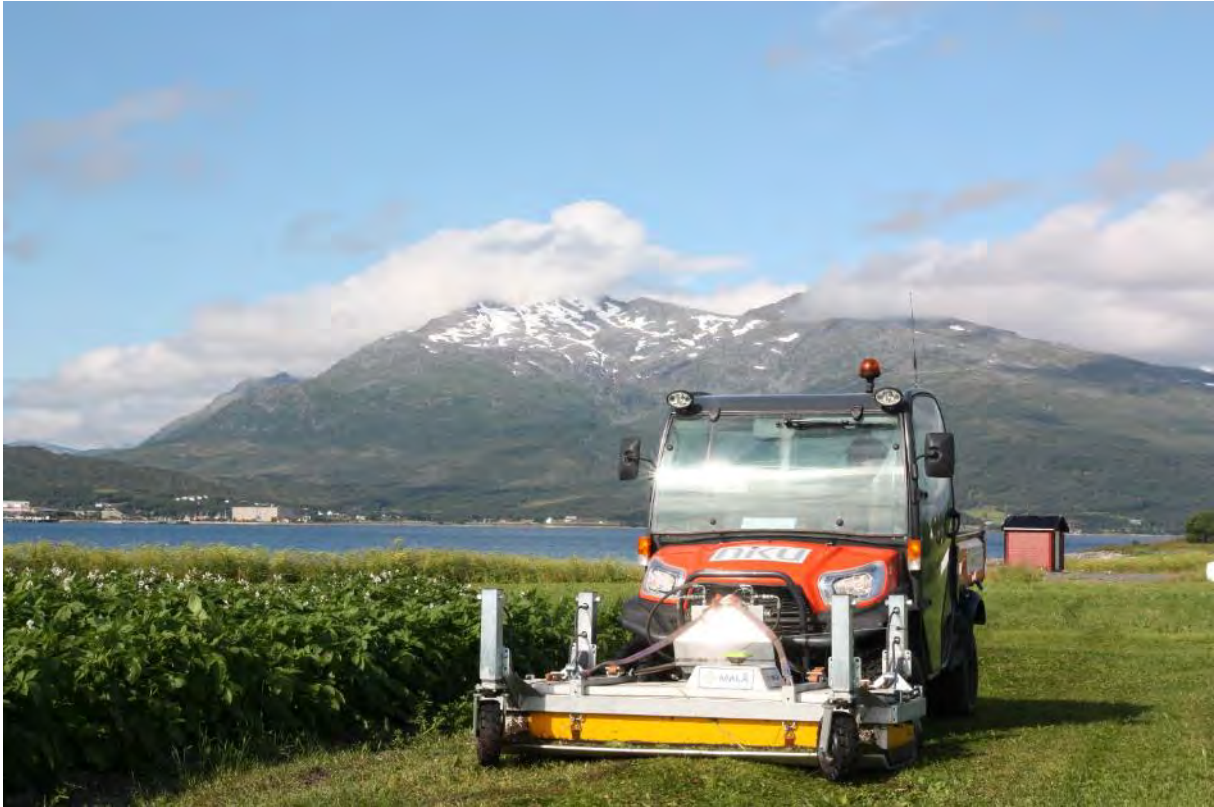
Figur 13 Georadarsystem av typen MALÅ MIRA IV. Foto: MG/NIKU.
